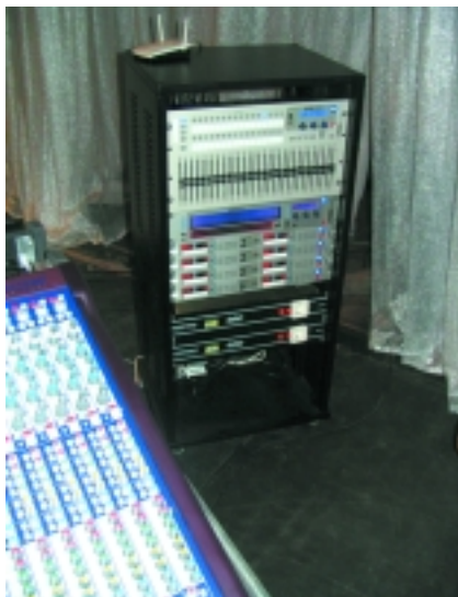
Рэк с приборами эквализации, управляемыми контроллером RAPIDE
