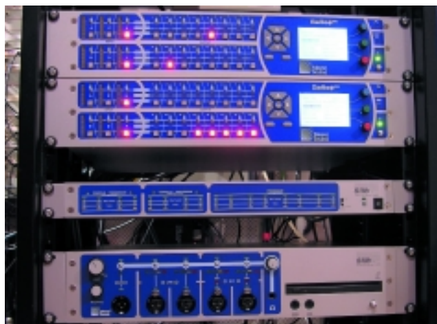
Система управления громкоговорителями Galileo 616 и аудиоанализатор SIM 3
