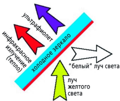
Рис. 3. Трансформация луча в ламповом модуле
