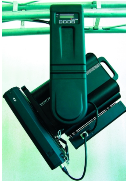
Лира Comandor. Видны панель управления с ЖК-индикатором, страховочный узел скроллера, и тросовый привод узла фокусировки под прожектором
