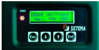
Панель управления лиры Comandor с ЖК-индикатором
