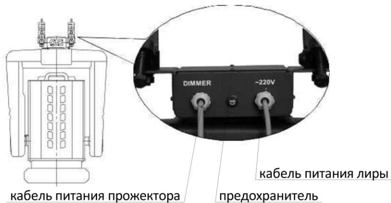
Рис. 2 – Расположение кабеля питания лиры и предохранителя
