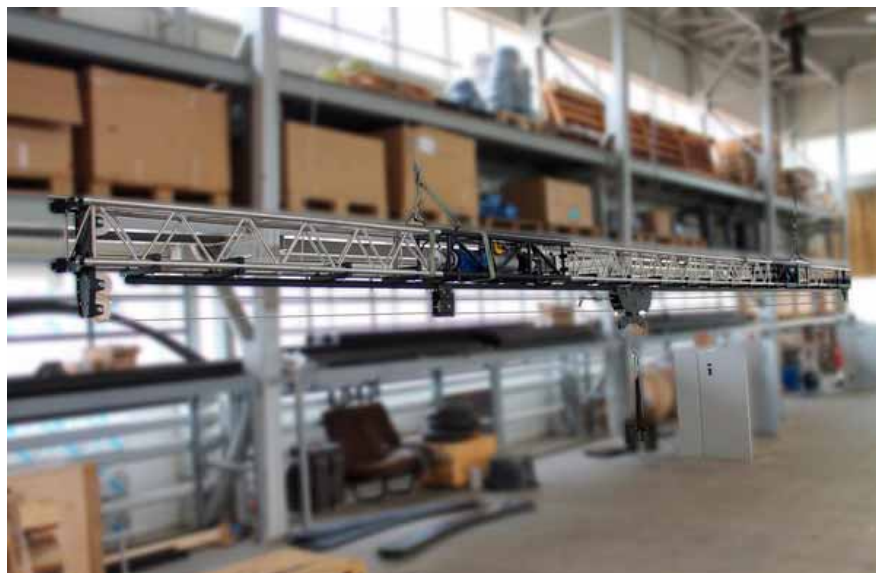
Механизм перемещения декораций — разработан и изготовлен в цехе фирмы «Система» в 2012 году
