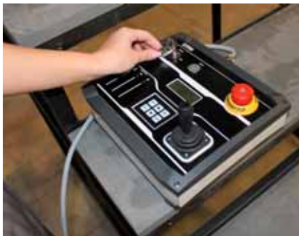
Специально разработанный малагабаритный пульт управления механизмом
